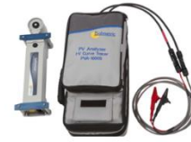
Thiết bị quét đường đặc tuyến I-V Solmetric PVA-1000S
