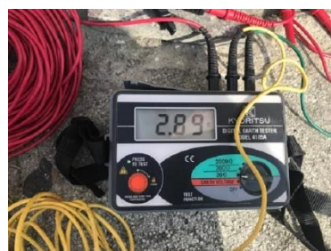
Kiểm tra điện trở nối đất
