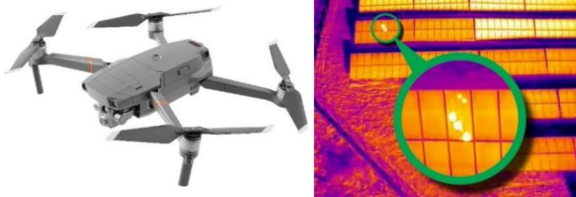
Kiểm tra tổng quát nhiệt độ các tấm pin bằng Flycam nhiệt
